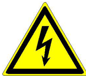
Рис. 4. Опасность поражения электрическим током
